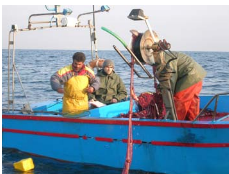
Figura 2.2.1. Imbarcazione armata con tremaglio salpato con verricello.
